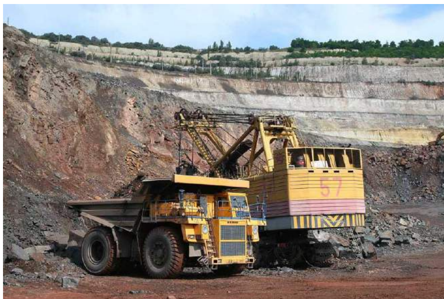
Рис. 4.8. Погрузка горной массы в автомобили БелАЗ (СГОК)
